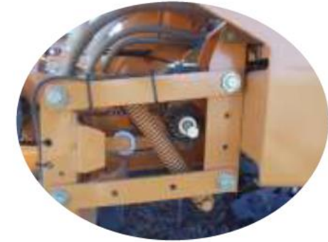
Sistema de resorte de presión en paralelogramos tradicional
