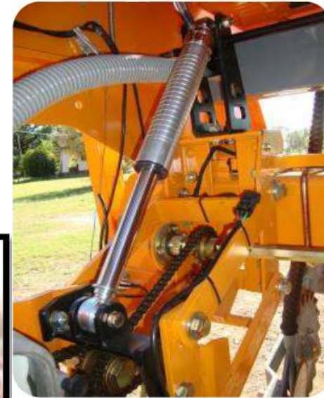
Sistema de resorte de presión en paralelogramos tradicional
